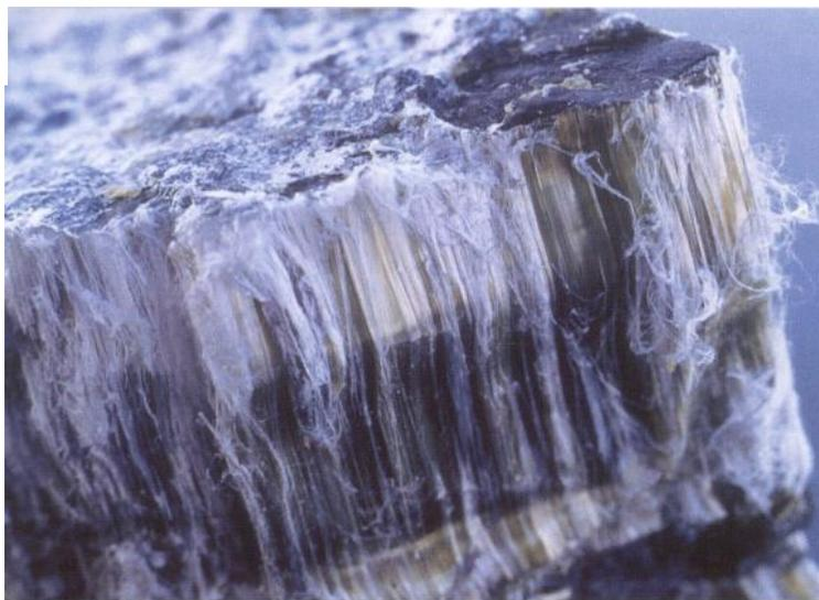
**Les fibres d'amiante** sont constituées de faisceaux de petites fibrilles. Elles présentent la particularité de pouvoir **se séparer** très facilement **dans le sens de la longueur** sous l'effet d'usinages, de chocs, de vibrations, de frottements pour constituer un nuage de **poussières très fines** pouvant se déposer partout et **pénétrer** au plus profond **des poumons.**
